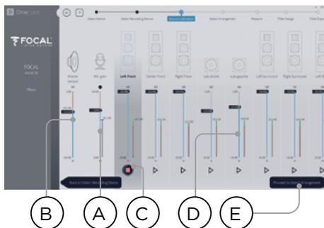
麦克风连接好之后, 确保房间安静。将输入增益调整为100% (B)。将输出音量 (A) 设置为低电平 (例如-40dB)。按第一个通道上的PLAY按钮 (C) 启动测试噪声, 调节音量到达通道仪表中的绿色区域。针对每个通道激活测试噪声并使用相应的滑块 (D) 校正通道音量, 使仪表到达绿色区域。请注意, 所有通道都会自动列出, 超低音扬声器可被自动识别。请记住, 重要的是多路扬声器和超低音扬声器已经单独对齐并分组, 因此将作为一个扬声器显示。点击“Proceed to Select Arrangement (继续并选择排列)” (E)。
