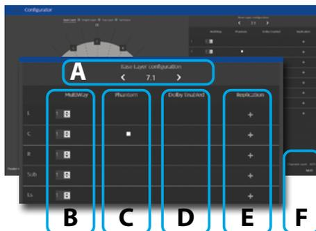
**A.** À l'aide des flèches gauche et droite, choisissez la combinaison d'enceintes prévue pour la disposition parmi les options pré-définies automatiquement ajoutées en fonction de la capacité de la version ISP à décoder des canaux.
