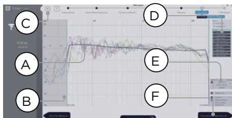
Cuando termine las mediciones, podrá visualizarlas para cada altavoz. Puede personalizar la curva objetivo de cada altavoz limitando la ventana de corrección (A) y arrastrando los puntos de anclaje de la curva objetivo a la posición deseada (B). Por defecto, se proporciona una curva típica de cine. Es posible guardar o cargar la curva objetivo en el menú (C). El diseño correcto de la curva objetivo está fuera del alcance de este documento, pero hay algunos puntos que debe recordar.
