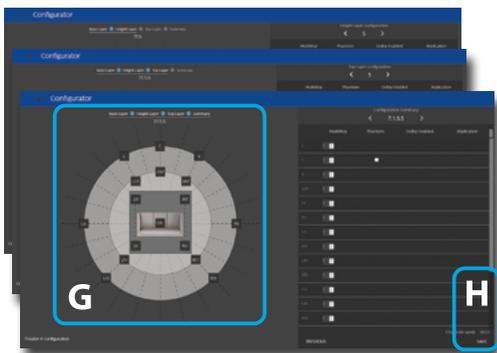
G. 最后将显示“Speakers Configuration（扬声器配置）”的概要。按照以下顺序进行四位数的描述：“Base Layer（底层）、LFE（LFE层）、Height Layer（高层）、Top Layer（顶层）”。
