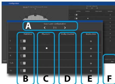
A. Com as setas da esquerda e da direita, escolha a combinação de coluna que pretende para a camada entre as opções predefinidas preenchidas automaticamente consoante a capacidade de descodificação dos canais da versão do ISP.
