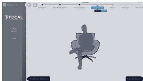
将麦克风放置在房间最佳听音位置 (Sweet Spot) 的人耳高度然后开始。麦克风必须位于房间的左右中心位置, 因为它将用于计算扬声器距离和电平。选择您要设置的排列。Chair (椅子) 适合单个聆听位置, Sofa Focused (窄沙发) 适合更宽阔的聆听位置, 但仍然环绕聆听者, Sofa Wide Imaging (沙发宽镜像) 适合更宽阔区域, 拥有更多的麦克风位置。按“Proceed to Measure (继续测量)”按钮开始测量。测量的波形图形实时更新。
