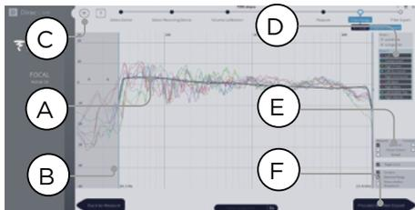
所有测量完成后，您可以查看每只扬声器的测量结果。您可以通过 (A) 限制校正窗口和 (b) 拖动定位点到目标曲线上的所位置来自设定每个扬声器的目标曲线。默认情况下，目标曲线为典型的影院曲线。可以通过菜单 (C) 保存或加载目标曲线。如何设计良好的目标曲线不在本文档探讨范围内，但这里指出一些需要记住的关键要点。
