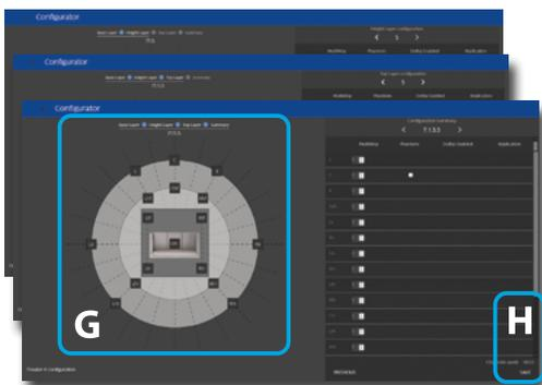
**Г.** По завершении настройки отобразится сводная информация о настройке громкоговорителей — Speakers Configuration. В следующем порядке будет отображено четырехзначное описание: Base Layer («Основной уровень»), LFE («Низкочастотный»), Height Layer («Верхний уровень»), Top Layer («Потолочный уровень»).
