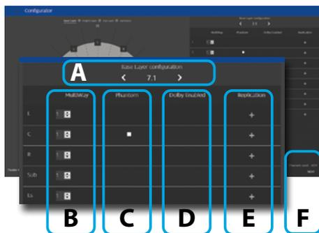
A. С помощью кнопок со стрелками выберите из предопределенных опций, настраиваемых автоматически в зависимости от присущих каналам определенной версии ISP возможностей декодирования, набор громкоговорителей для каждого уровня установки.
