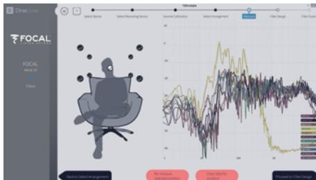
完成所有9或16次测量后，点击“Proceed to filter design (继续进行滤波器设计)”。
