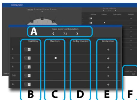
**A.** Seleccione con las flechas izquierda y derecha la combinación de altavoces que ha previsto para cada capa, entre las opciones predefinidas automáticamente en función de la capacidad de decodificación de canales de la versión del ISP.
