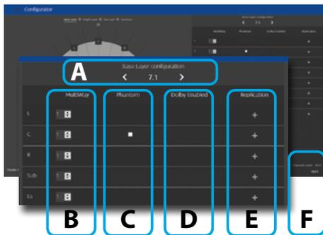
A. 使用左右箭头，根据ISP版本的信道解码能力从自动弹出的预设选项中选择您想在该层使用哪种扬声器组合。
