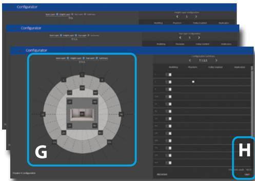
**G.** No fim, será apresentado um resumo para a "Speakers Configuration" (Configuração das colunas). É apresentada uma descrição de quatro dígitos pela seguinte ordem: "Base Layer" (Camada base), "LFE", "Height Layer" (Camada em altura), "Top Layer" (Camada de teto).
